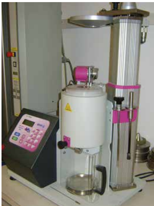
Il plastometro utilizzato per la determinazione del M.F.I.
