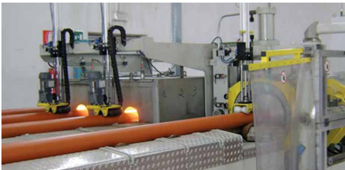
La formatura del bicchiere di TriPplo+, eseguita con macchinari moderni che assicurano la massima precisione dimensionale, contribuendo all'ottima tenuta idraulica
